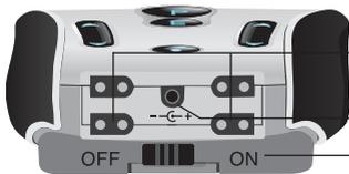
6. Prises de sortie pour le branchement des câbles et électrodes
