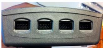
Pour relier les câbles au dispositif introduire les connecteurs dans les emplacements prévus positionnés dans la partie supérieure de l'unité (voir photo). Les emplacements sont positionnés exactement sous les canaux correspondants.
