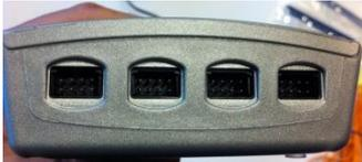
Pour relier les câbles au dispositif introduire les connecteurs dans les emplacements prévus positionnés dans la partie supérieure de l'unité (voir photo). Les emplacements sont positionnés exactement sous les canaux correspondants.
