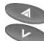
Para aumentar la intensidad del canal izquierdo (L) presionar el boton en correspondencia a la flecha ▲ siempre manteniendo una estimulacion confortable.
