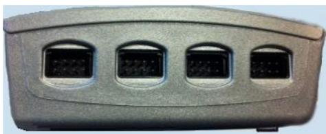
Pour relier les câbles au dispositif introduire les connecteurs dans les emplacements prévus positionnés dans la partie supérieure de l'unité (voir photo). Les emplacements sont positionnés exactement sous les canaux correspondants.
