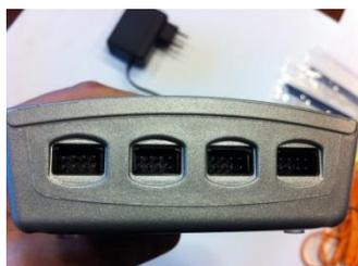
Pour relier les câbles introduire les connecteurs dans les emplacements prévus positionnés dans la partie supérieure de l'unité (voir photo). Les emplacements sont positionnés exactement sous les canaux correspondants.
