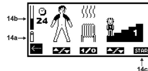
**14a** Le **symbole de la petite pile clignote**: le niveau de charge des batteries devient faible. Interrompez la séance et rechargez l'appareil (cf. rubrique précédente: "Recharge").
