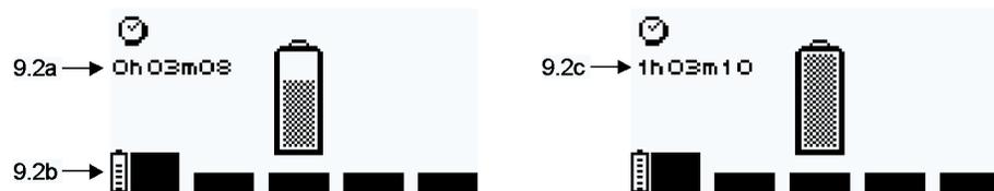
**9.2a** Le **Compex est en charge** depuis 3 minutes et 8 secondes (une charge complète peut durer plus de deux heures). La grosse pile centrale est animée.
