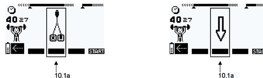
**10.1a** Le Compex "bipe" et affiche alternativement le symbole d'une paire d'électrodes et celui d'une flèche pointant sur le canal qui rencontre un problème. Ci-dessus, le stimulateur a détecté un **défaut d'électrodes sur le canal 2**. Ce message peut signifier:
