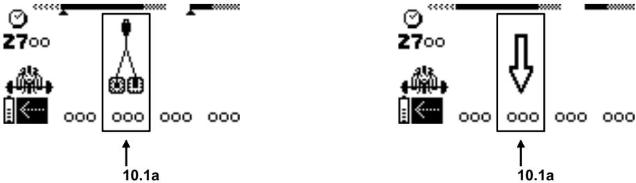
**10.1a** Le Compex “bipe” est affiché alternativement le symbole d'une paire d'électrodes et celui d'une flèche pointant sur le canal qui rencontre un problème. Ci-dessus, le stimulateur a détecté un **défaut d'électrodes sur le canal 2**. Ce message peut signifier:
