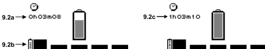
**9.2a** Le **Compex est en charge** depuis 3 minutes et 8 secondes (une charge complète peut durer plus d'une heure et demie). La grosse pile centrale est animée.
