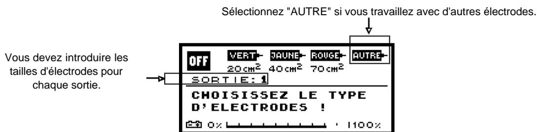
**Attention :** pour une même sortie, l'électrode positive et l'électrode négative doivent toujours avoir la même surface.
