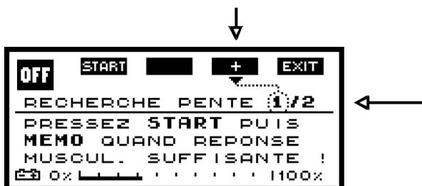
La recherche automatique de pente fonctionne de la manière suivante : toutes les demi-secondes (500 millisecondes), le stimulateur génère une impulsion à pente d'une largeur de 100 millisecondes et d'une intensité qui augmente progressivement.
