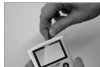
Figure 3-6 Connexion des câbles de stimulation au dispositif
