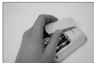
Figure 3-4 Retrait/fixation du clip de ceinture
