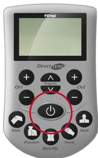
Figure 4-1 Mise en marche du stimulateur
