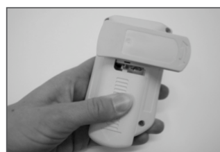
Figure 3-2 Ouverture du compartiment des batteries
