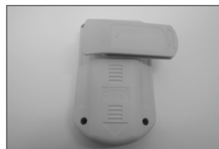
Figure 3-1 Rotation du clip ceinture
